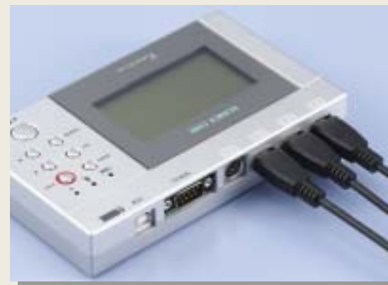
センサ接続例(3チャンネル使用時)
