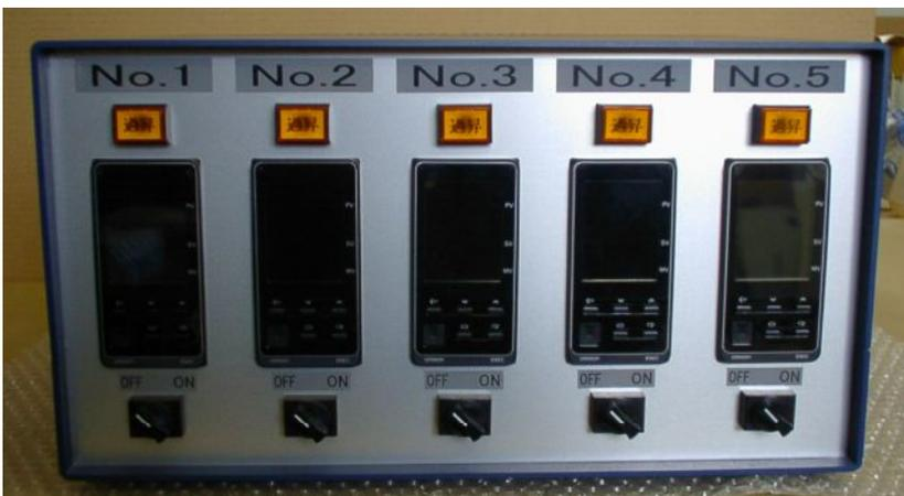
伝送出力付5連温度制御装置(電機メーカー)
