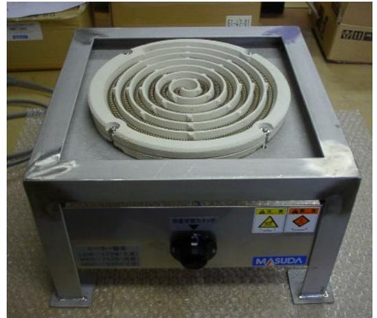
100V3kW(3連式) / 1.5kWの電熱器
