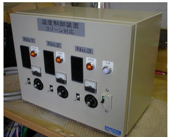
3ゾーン管状炉用温度制御装置
